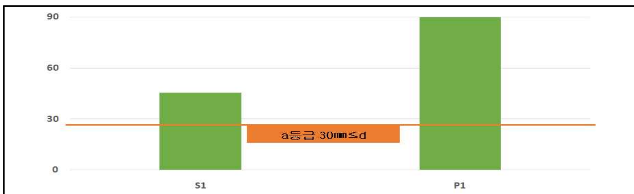
【그림 3.10】 탄산화 깊이 측정결과
