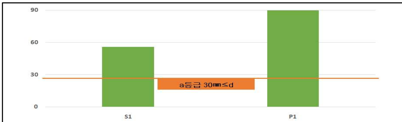
【그림 3.10】 탄산화 깊이 측정결과
